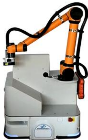
轨道智能列检机器人
