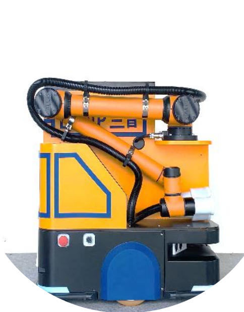
轨道智能列检机器人
